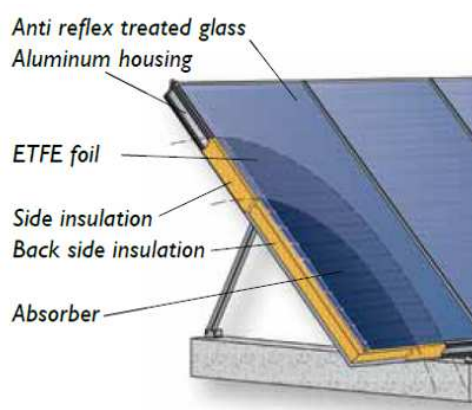
Figure 2 - Exemple de capteurs plan hautes performances : Capteur plan avec film téflon grande surface (marque ARCON – à gauche) et capteur plan avec double-vitrage (marque SCHUCO – à droite)
